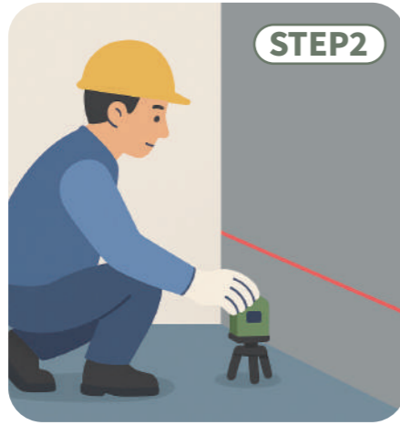
STEP2 紅外線水平儀定位
